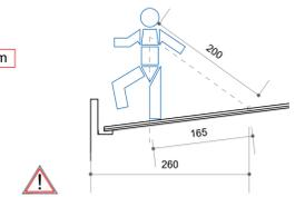
AREA DI RAGGIO m 2,60 RAGGIUNGIBILE ATTRAVERSO L'USO COMBINATO DEL CORDINO DI m 2,00 E SISTEMA ANTICADUTA IN TRATTENUTA
